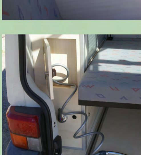
Buitendouche is extra beveiligd d.m.v. elektrische schakelaar. Zodat de douche niet perongeluk kan gaan stromen wanneer deze binnen in de kast zit.
